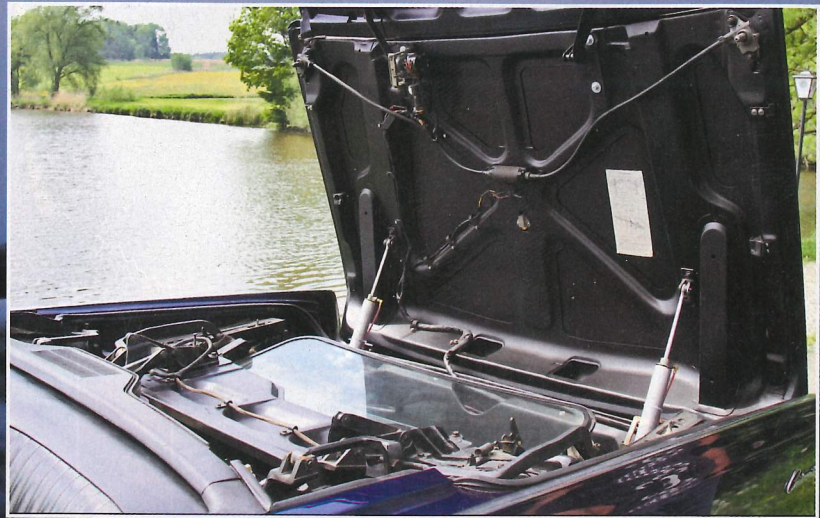
Diese Hydraulik stemmt den riesigen Kofferraumdeckel mit Leichtigkeit und eröffnet dem Verdeck weitreichende Entfaltungsmöglichkeiten
