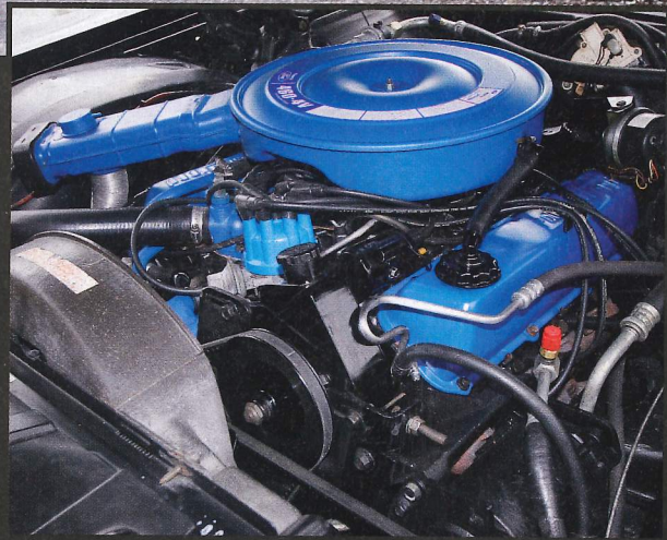
Der 460 cui große Ford V8 verdient die Bezeichnung "Big Block" in jeder Hinsicht
